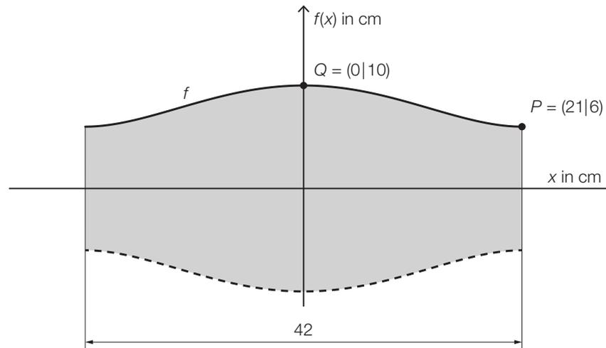
Die obere Begrenzungslinie lässt sich näherungsweise durch den Graphen der Funktion  $f$  mit  $f(x) = a \cdot x^4 + b \cdot x^2 + c$  beschreiben. Im Punkt  $P$  verläuft die Tangente an den Graphen der Funktion  $f$  waagrecht.
