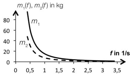
Bei gleicher Masse ist die Schwingungsfrequenz  $f$  bei kleinerer Federkonstante geringer.
