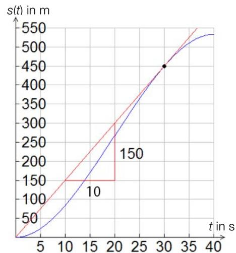
Die Momentangeschwindigkeit entspricht der Steigung der Tangente bei  $t = 30$  s und beträgt rund  $\frac{150}{10} \frac{\text{m}}{\text{s}} = 15 \frac{\text{m}}{\text{s}}$ .
