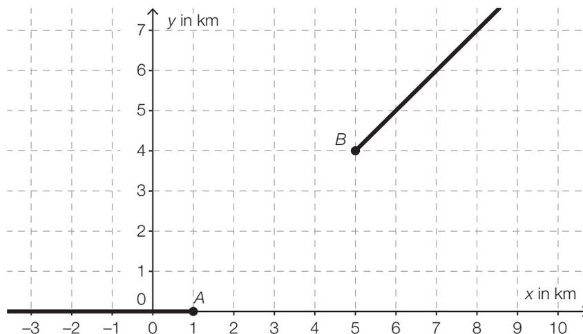
Diese Gleise sollen durch ein Gleisstück knickfrei verbunden werden. „Knickfrei“ bedeutet, dass die entsprechenden Funktionen an den Stellen, an denen sie zusammenstoßen, den gleichen Funktionswert und die gleiche Steigung haben.
