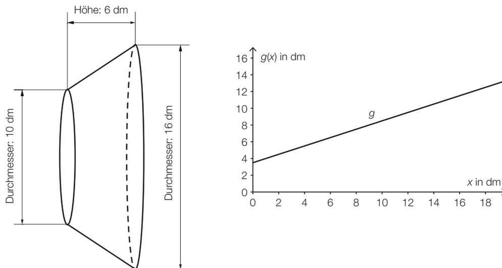
Dieser Kegelstumpf kann als Rotationskörper mithilfe der Funktion  $g$  beschrieben werden:
