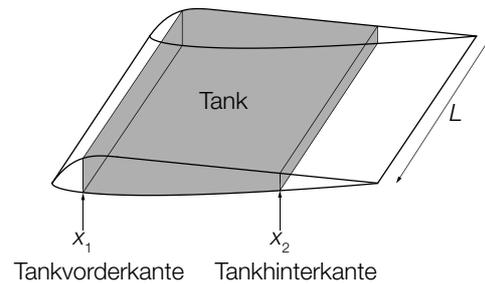
Der Querschnitt eines Flügels dieses Kleinflugzeugs kann durch die Graphen der Funktionen  $f_1$ ,  $f_2$  und  $g$  modelliert werden. An der Stelle  $x = 0,2$  geht der Graph von  $f_1$  in den Graphen von  $f_2$  über.
