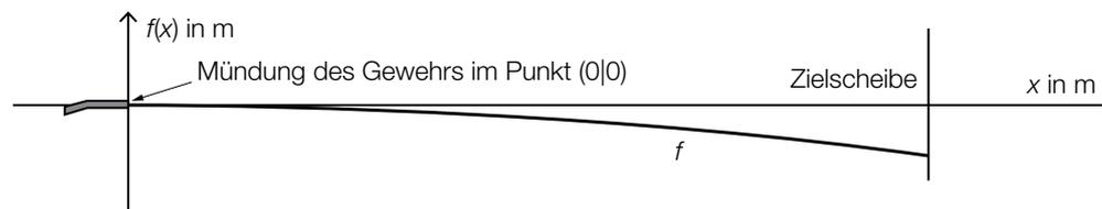
Die Flugbahn eines Projektils kann unter Vernachlässigung des Luftwiderstands näherungsweise durch den Graphen einer Polynomfunktion 2. Grades  $f$  mit  $f(x) = a \cdot x^2 + b \cdot x + c$  beschrieben werden.
