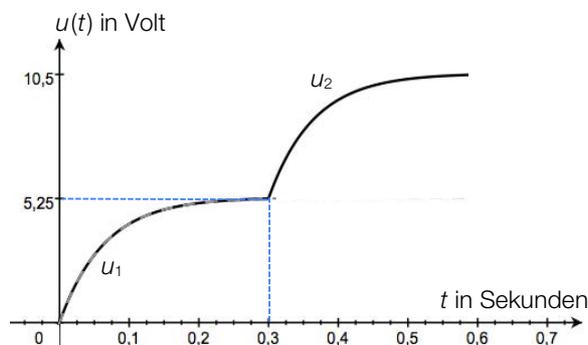
Nach 0,3 Sekunden ist der Kondensator auf eine Spannung von 5,25 V aufgeladen.
