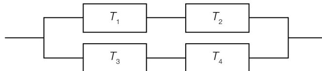
Jedes der Bauteile  $T_1$ ,  $T_2$ ,  $T_3$  und  $T_4$  hat die gleiche Zuverlässigkeit  $p$ .
