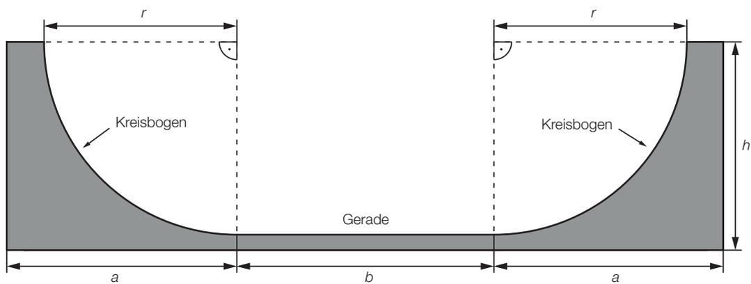
1) Erstellen Sie eine Formel für die Berechnung des Flächeninhalts  $A$  der grauen Fläche (Querschnittsfläche) aus  $a$ ,  $b$ ,  $h$  und  $r$ .
