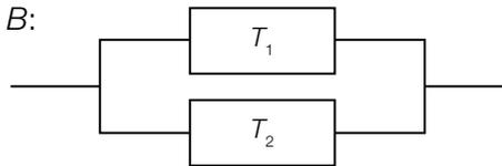
Die beiden Bauteile  $T_1$  und  $T_2$  haben jeweils die gleiche Zuverlässigkeit  $p$ .
