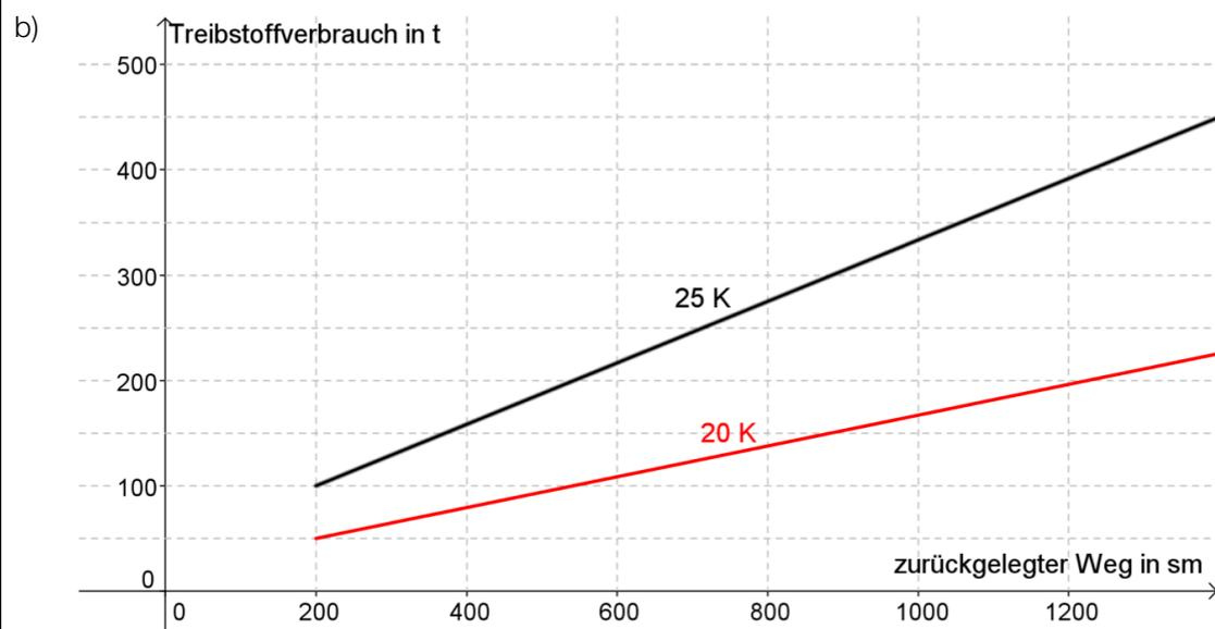
Die Steigung der Geraden wird halbiert, wenn die Treibstoffverbrauch um 50 % reduziert wird.
